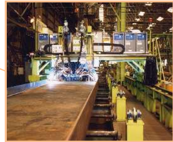
※腹板・フランジの溶接
