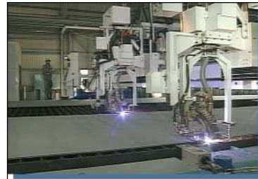
プラズマ切断
