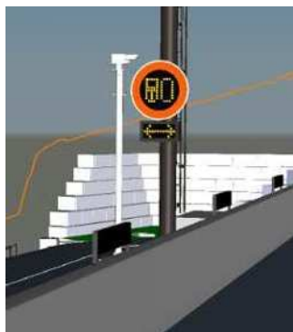
図 3-6 8 速度規制標識設備の 3 次元モデル作成例
