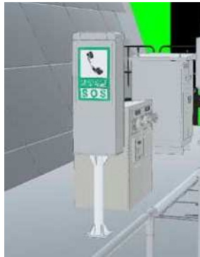
図 3-6 7 非常電話設備の3次元モデル作成例
