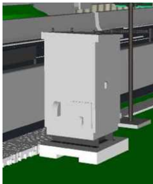
図 3-7 3 引込設備の3次元モデル作成例
