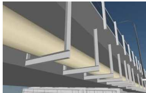
桁外側の添架物
