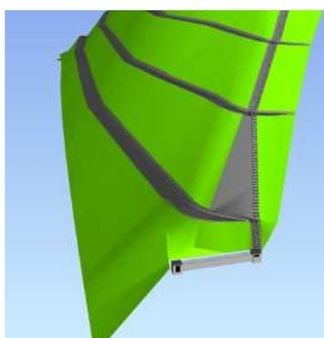
図 3-10 切土の3次元モデル作成例
