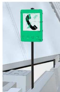
図 3-67 非常電話設備の3次元モデル作成例
