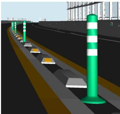
図 3-4 1 車線分離標の 3 次元モデル作成例
