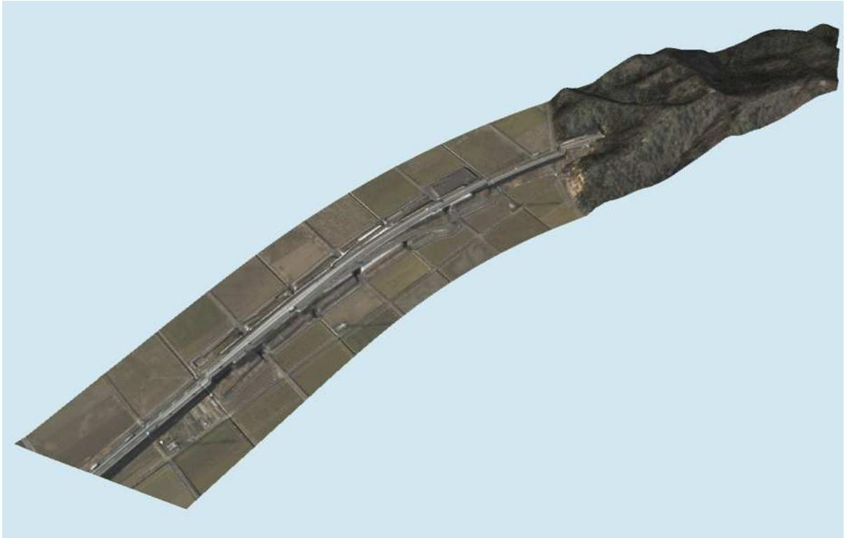
図 3-6 地形モデルの 3 次元モデル作成例
